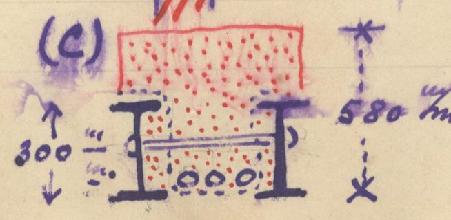
L'entraînement est inutile, car toute la division en brique foudée sur le béton armé. Les poutrelles (m) (n) (o) sont inutiles, car la division en briques les remplace. Elles servent seulement pour relier la maison.
